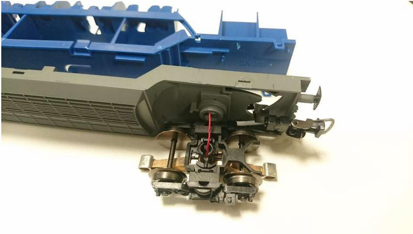
10. Nach dem das Drehgestell wieder eingerastet wurde, kann die Inneneinrichtung wieder aufgesetzt werden. Es empfiehlt sich das Kabel „nach links zu fixieren“ Anschließend kann das Kabel wieder an die Position „WL“ angelötet werden.
