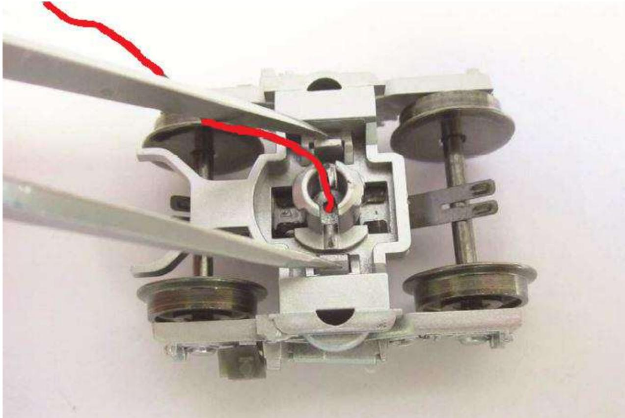
5. Achsschleifer von der Halteplatte lösen (Blech-Laschen aufbiegen und nach unten herausziehen)
