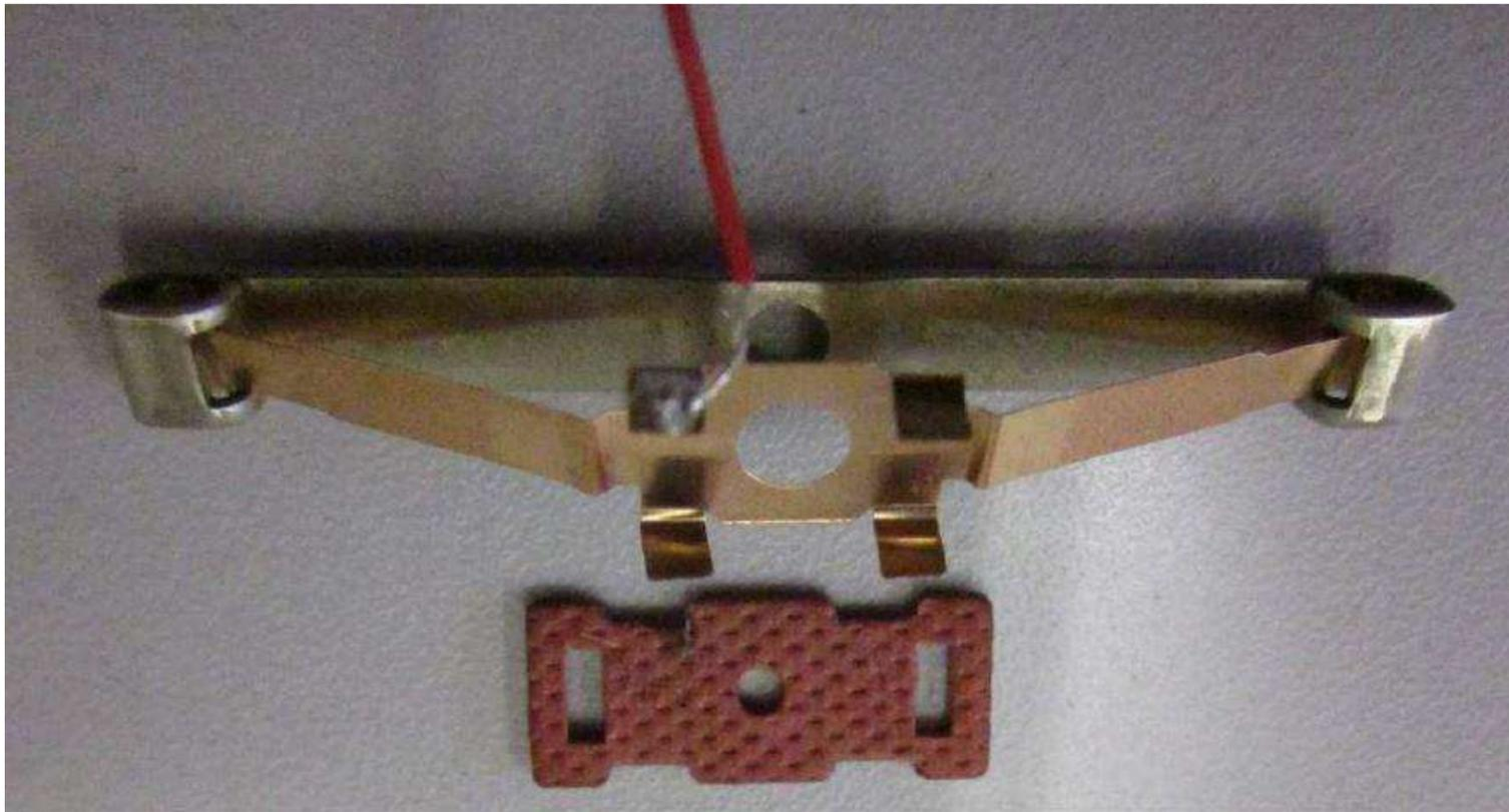
7. Rasthaken der Halteplatte zeigen nach oben – Schleider wird von unten eingesteckt; danach die Laschen zur Fixierung umbiegen
