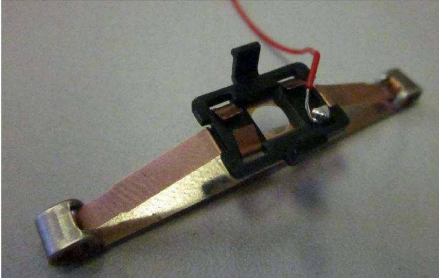
8. Radschleifer mitsamt Halteplatte an Drehgestell anklipsen – dabei auf das Kabel achten, damit dieses nicht beschädigt wird.
