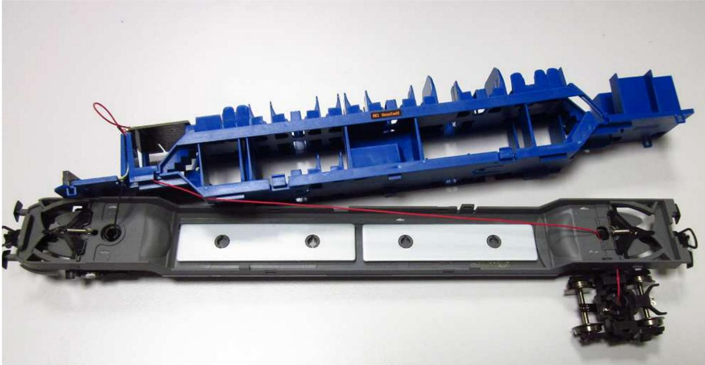
4. Radsätze herausnehmen und Halteplatte des Achsschleifers lösen (Rasthaken auf der Innenseite nach unten herausdrücken)
